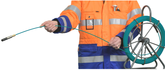
PL18-33-sondi kiinnitettynä työntövaijeriin PL-MSA-adapterin avulla.
