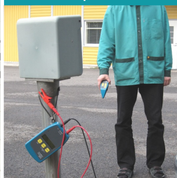
Etsi sähkösyöttöjen ja muiden kaapeleiden reitit
