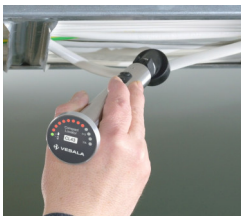
Kaapelin tunnistusta arinalta
